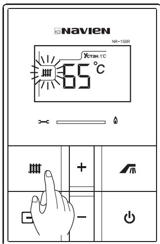
2. Нажав кнопку + или – установите желаемую температуру отопления.
