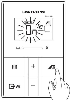
При выборе функции <Вне дома> на дисплее появится значок
