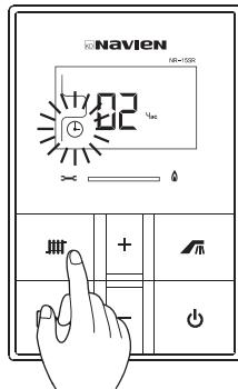
При выборе функции таймера отопления мигает значок
